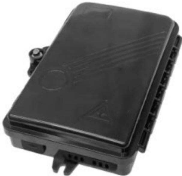
La caja FTTH de 4 hilos, está diseñada para conectar el cable de alimentación/distribución al cable de caída del abonado usando el divisor PLC en las redes. Tiene 1 puertos de entrada y 6 puertos de salida en la parte inferior y es fácil de instalar en la pared o poste. La bandeja trasera sirve para empalmar una fibra de cable alimentador con divisor PLC y la bandeja frontal para conectar el cable de caída del abonado a través de la placa adaptadora de la bandeja.
